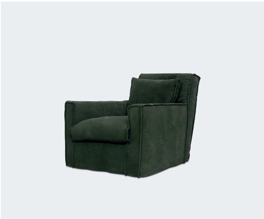
Struttura in legno tamburato di abete e pioppo. Piedini in faggio tinto noce. Imbottitura in poliuretano espanso a densità differenziata e fodera realizzata con fibre acriliche. Molleggio a nastri elastici intrecciati di caucciù rivestito. Cuscineria di seduta e poggiatesta in memofil con chips in viscoelastico. Rivestimento con cuciture a filo vivo.
