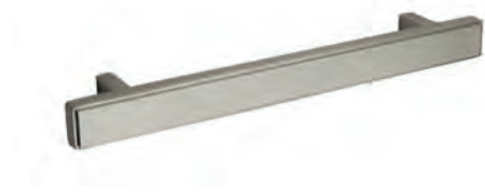
Maniglia 583 finitura nichel satinato anta L 15 → passo 160 mm in verticale anta da L 30 a L 45 → passo 160 mm anta da L 60 a L 120 → passo 320 mm
